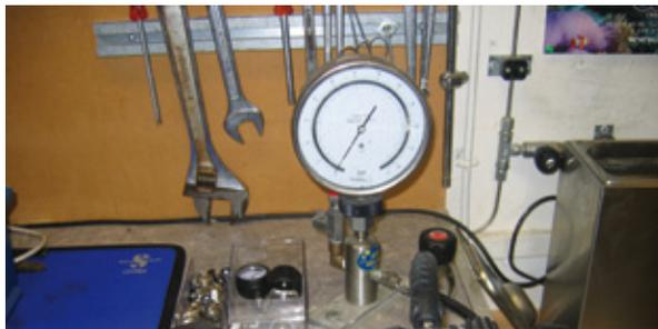
Ils sont utilisés après le remontage du détendeur pour effectuer les réglages selon les recommandations des constructeurs.
