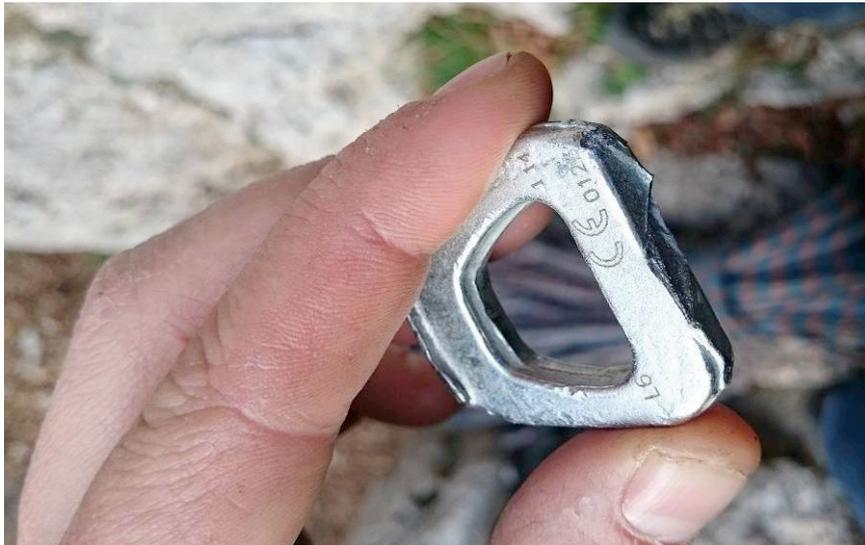
La rupture est due a un nouvel outillage d'estampage à chaud créant un raccord légèrement différent entre la lame et la tête du piton à partir du lot **1 14**.
