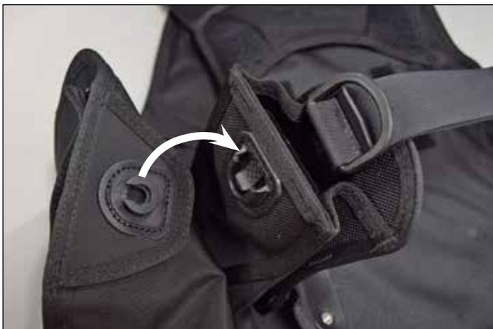
**7** Faites passer le bout de la sangle en forme de T sur la partie supérieure du lobe de la vessie, par la ceinture et dans la coulisse du bas de la vessie. Recommencez de l'autre côté.
