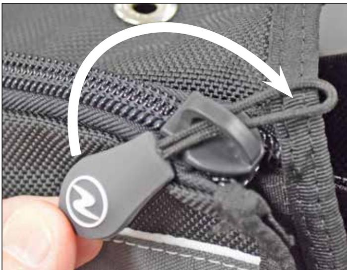
**6** Faites passer l'attache de l'inflateur à travers la sangle d'épaule. Fixez les autoagrippants qui maintiennent la sangle dans sa position. Enroulez l'attache autour de l'inflateur.
