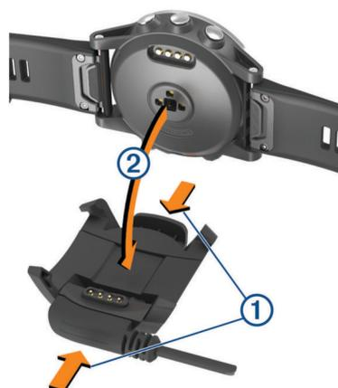
4 Contacts alignés, placez l'appareil dans le socle ② et relâchez les bras pour maintenir l'appareil en place.
