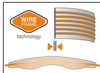
Des fils en polyéthylène haute ténacité se déploient dans la ceinture et les cuisses et permettent une répartition optimale de la charge en suspension et un excellent confort même en l'absence totale de mousses.
