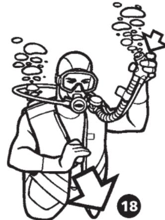
**C > Valvola di scarico Inferiore:** si trova sul retro, in basso a destra del jacket.
