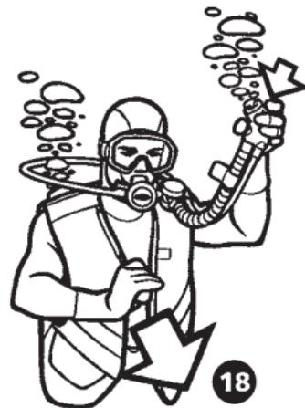
**C > Válvula de descarga Inferior:** encontra-se na parte posterior do seu colete, do lado direito inferior.
