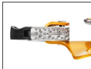
Gâchette à picots avec fente d'évacuation pour optimiser le fonctionnement, quelles que soient les conditions (corde gelée, boue...).
