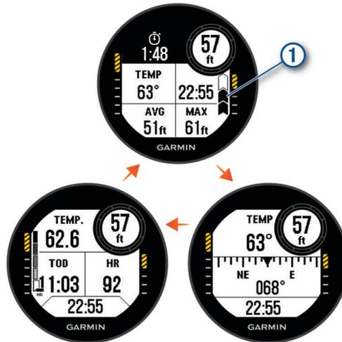
**Chronomètre de plongée** : affiche le chronomètre de temps passé au fond, la profondeur maximale, ainsi que la vitesse de remontée (*Utilisation du chronomètre de plongée avec profondimètre, page 19*).
