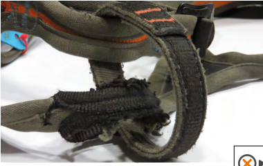
• Point d'encordement usé
